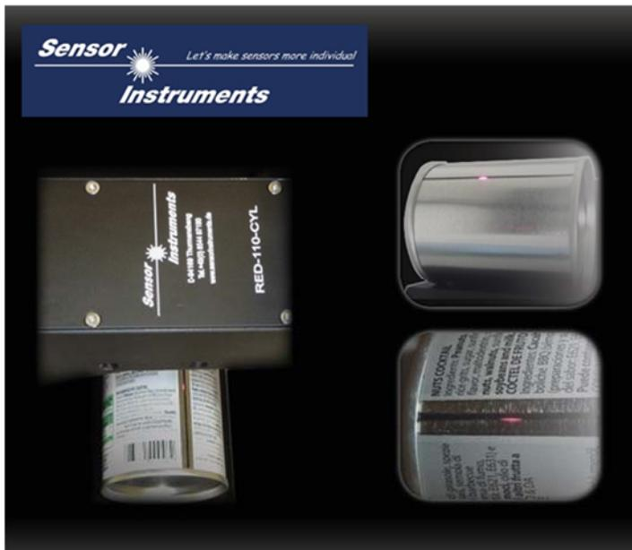
L'optique de bord du capteur RED dirige un point laser sur la surface de l'objet.
